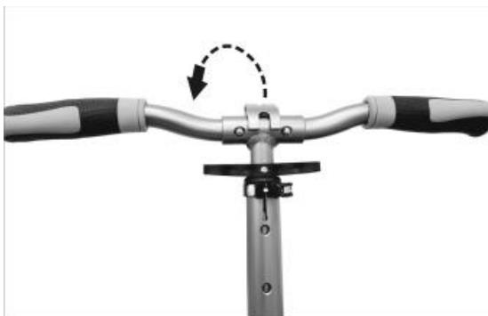
Ahora, debe cerrar la palanca de cierre rápido nuevamente. Asegúrese de que el cierre rápido se cierre bajo tensión. Si la tensión no es suficiente, ajuste la contratuerca estriada.
