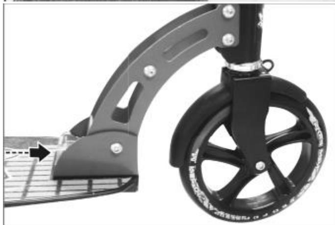
Cuando el scooter esté completamente desplegado, el deslizador se bloqueará automáticamente.
